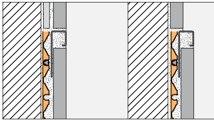
Variante de instalación: Perfil para delimitar el área calefactada de pared Schlüter®-QUADEC
