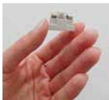
3. Cambie el fusible defectuoso por un cartucho fusible G 5 x 20 mm, véase la tabla 1.
