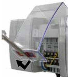
Ejemplo de cambio de fusible en el Módulo Básico "Control".
