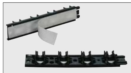
Schlüter-BEKOTEC-THERM-RH 75 es una pinza que se utiliza para fijar los tubos de calefacción en los nódulos de la placa BEKOTEC. Se recomienda especialmente en aquellos casos en que sea necesario colocar los tubos calefactores de Ø 16 mm en la placa de nódulos en un ángulo de 45°.
