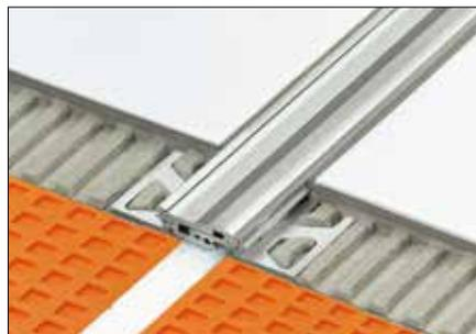
Schlüter-DILEX-BT es un perfil para juntas de movimiento estructurales de aluminio con conexión lateral articulada y parte central machihembrada. Con ello es posible una absorción tridimensional de movimientos (ver ficha técnica del producto 4.20).
