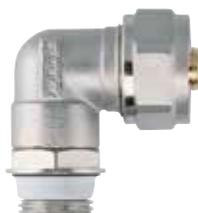
Schlüter-BEKOTEC-THERM-AW es un ángulo de empalme girable de latón niquelado. Por un lado con una rosca exterior estanca de 1/2" (DN 15) y por el otro lado con una rosca de apriete de 3/4" (DN 20) para el empalme al tubo de calefacción Schlüter de 14 o 16 mm.
