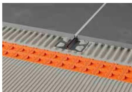
Schlüter-DILEX-FCS es un perfil soporte de junta de movimiento prefabricado y estrecho, provisto de alas de sujeción con orificios trapezoidales fabricado con PVC rígido reciclado, que forma una junta de movimiento estrecha de aprox. 3,5 mm sin protección de cantos y que se instala sin necesidad de rejuntado. La cubierta de protección integrada se retira después de la colocación de la cerámica para alojar el inserto de silicona Schlüter-DILEX-FIS. (Ficha técnica 4.23)
