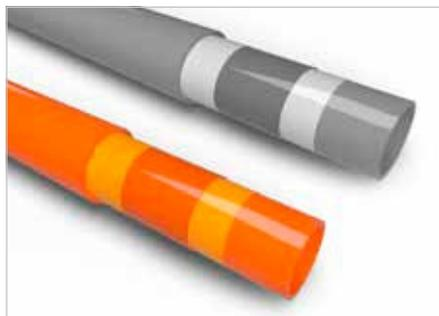
Schlüter-BEKOTEC-THERM-HR es un tubo de calefacción compuesto de 5 capas de alta calidad (PE-RT), con una barrera antidifusión de oxígeno. El tubo de calefacción altamente flexible, fabricado según la norma DIN 16833, es apto para su óptima colocación en las placas de nódulos del sistema BEKOTEC. La barrera antidifusión de oxígeno está certificada según la norma DIN 4726 y se supervisa continuamente para garantizar su calidad.
