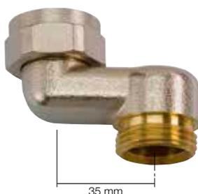
Schlüter-BEKOTEC-THERM-S35 es una pieza de empalme en forma de S de latón niquelado. Por un lado con una tuerca racor cónica de 3/4" (DN 20) y por otro lado con un racor de empalme cónico de 3/4" (DN 20) para la conexión de los tubos de calefacción con un diámetro de 10, 12, 14 o 16 mm.
