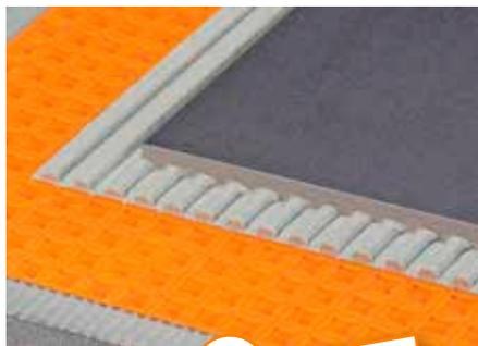
Schlüter-DITRA es una lámina de polipropileno de estructura cuadrículada con diseño Easyfill, cuyo reverso está previsto de un geotextil. La lámina DITRA actúa como desolidarización, impermeabilización y equilibrio de la presión de vapor en contacto directo con el recubrimiento cerámico.
