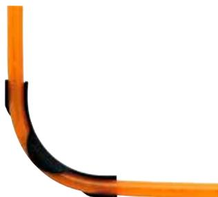
Schlüter-BEKOTEC-THERM-ZW es una curva de plástico, que se utiliza para definir un ángulo de 90° en los tubos de calefacción de diámetro 10, 12, 14 y 16 mm que salen del armario de distribución al recrecido. Su colocación sobre el tubo de calefacción es sencilla. Se recomienda su uso debido al espesor relativamente bajo del recrecido, facilitando así la instalación del armario de distribución.
