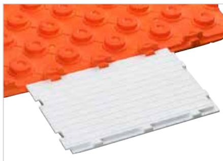
Schlüter-BEKOTEC-ENR es un panel perimetral de poliestireno, que evita utilizar una placa entera de nódulos, en aquellos casos en los cuales no sea necesario colocar tubos de calefacción, (p. ej. pasos de puertas, huecos pequeños). También puede utilizarse delante de los colectores del circuito de calefacción para facilitar la instalación de los tubos de calefacción.
