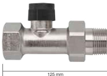
Schlüter-BEKOTEC-THERM-ZV es una válvula de sectorización, que regula todos los circuitos de calefacción conectados al colector del circuito de calefacción. La válvula de sectorización se controla a través de una electroválvula de Schlüter. La regulación puede realizarse a través de un termostato BEKOTEC o de un termostato DITRA-HEAT-E. Conexión/Material: Tornillos/Válvula 1" (DN 25) de cobre niquelado.
