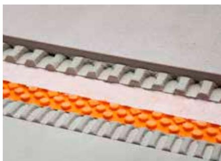
Schlüter-DITRA-DRAIN 4 es una lámina de polietileno resistente a la presión con una estructura especial de nódulos y fieltro de polipropileno en su parte superior. La lámina es un soporte de colocación para recubrimientos cerámicos con las funciones de capa de desolidarización y drenaje con capilaridad pasiva.
