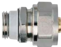
Schlüter-BEKOTEC-THERM-AN es una rosca de empalme de cobre niquelado. Por un lado con una rosca exterior estanca de 1/2" (DN 15) y por el otro lado con una rosca de apriete de 3/4" (DN 20) para el empalme al tubo de calefacción Schlüter de 14 o 16 mm – apto para todos los accesorios Eurokonos.
