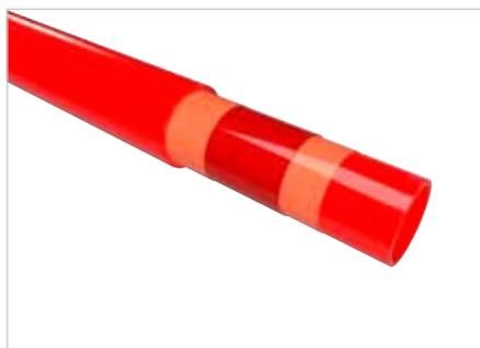
Schlüter-BEKOTEC-THERM-HR es un tubo de calefacción compuesto de 5 capas de alta calidad (PE-RT), con una barrera antidifusión de oxígeno. El tubo de calefacción altamente flexible, fabricado según la norma DIN 16833, es apto para su óptima colocación en las placas de nódulos del sistema BEKOTEC. La barrera antidifusión de oxígeno está certificada según la norma DIN 4726 y se supervisa continuamente para garantizar su calidad.
