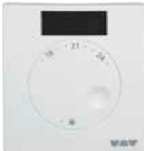
Schlüter-BEKOTEC-THERM-ER/WL es un termostato inalámbrico extraplano con opción "frío/calor". La temperatura de consigna se puede regular entre 8 y 30 °C (en caso de ser necesario, se puede limitar) y se transmite al módulo de conexión de los sensores de la sala EAR 2/6 WL de forma inalámbrica. El temporizador con reloj digital EET permite controlar la caída de temperatura. El suministro de energía se realiza a través de una celda solar integrada, alternativamente con una pila de botón incluida.
