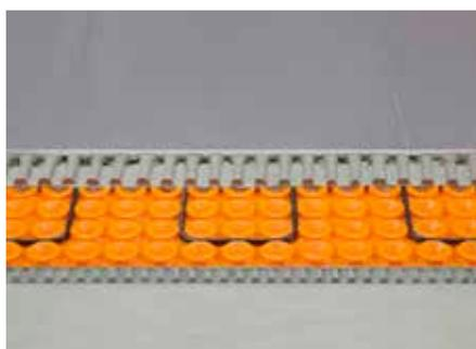
Schlüter-DITRA-HEAT es una lámina de polipropileno con una estructura de nódulos, cuyo reverso está cubierto con un geotextil. La lámina es un soporte universal para recubrimientos cerámicos con las funciones de desolidarización, impermeabilización y equilibrio de la presión de vapor. Al mismo tiempo es apta para la instalación de cables calefactores para el calentamiento de suelos y paredes.
