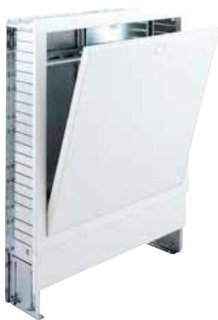
Schlüter-BEKOTEC-THERM-VSE es un armario empotrable en la pared que oculta el distribuidor de Schlüter y sus restantes componentes. El armario está fabricado en acero inoxidable galvanizado y dispone de estructuras de refuerzo para su estabilización, así como una serie de perforaciones en sus laterales en los que se insertan las tuberías de conexión. La superficie (la puerta y los marcos) están lacados con pintura en polvo.
