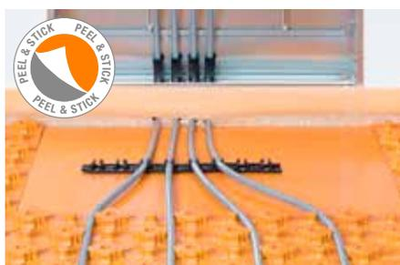
La placa lisa Schlüter-BEKOTEC-ENFG-PS se instala delante de los colectores de calefacción para facilitar las conexiones y minimizar los cortes. La placa es autoadhesiva por la parte posterior y dispone de un film de protección.
